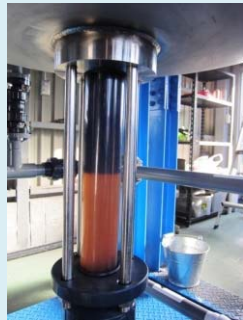
抜き出し中の油水界面
