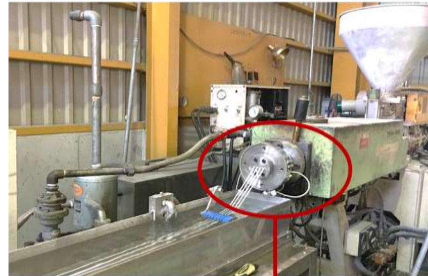
溶融樹脂溜り部 (先細り形状型: T-type)
