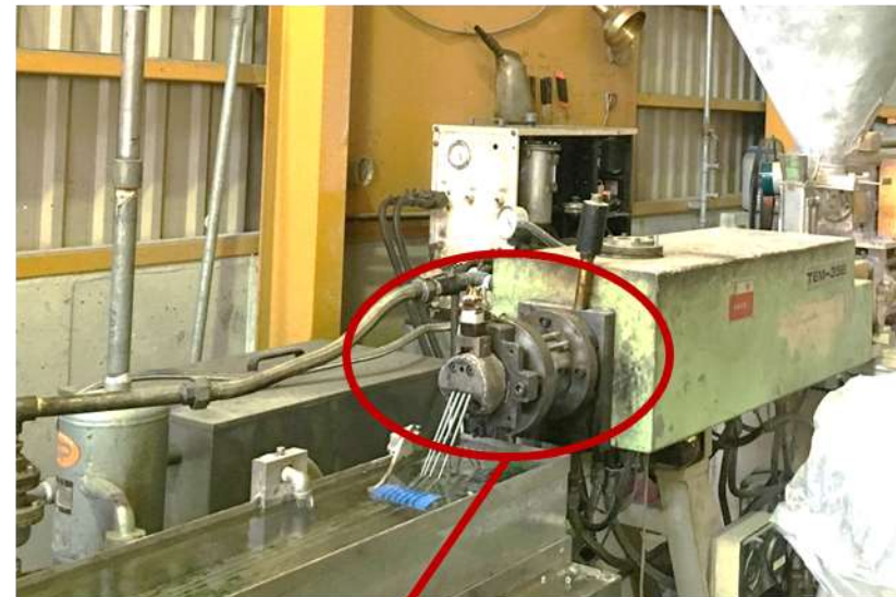
新技術 熔融樹脂溜りを設けた押出機
