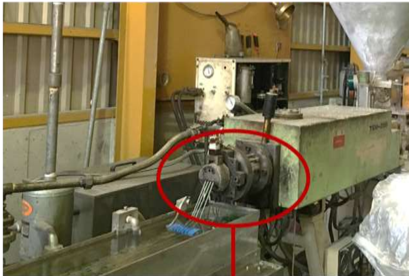
溶融樹脂溜り部 (直管型: S-Type)
