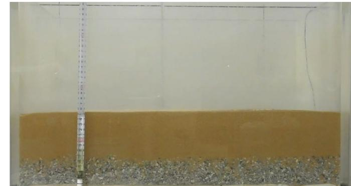
✓ 無補強では、150galで下部に碎石層を敷いた条件でも過剰間隙水圧の上昇がみられ、液状化が確認できた。
