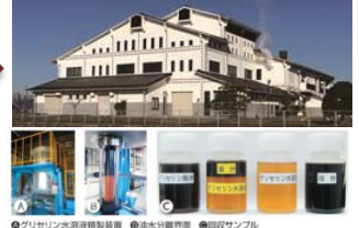
BDF製造副生物から精製されたグリセリン水溶液のし尿処理施設における脱窒剤利用 (クボタ環境サービス・フチガミ)
