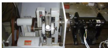
ねじりトルク発生部 ← → 試験部
