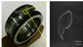
玉軸受のフレーキング破壊
