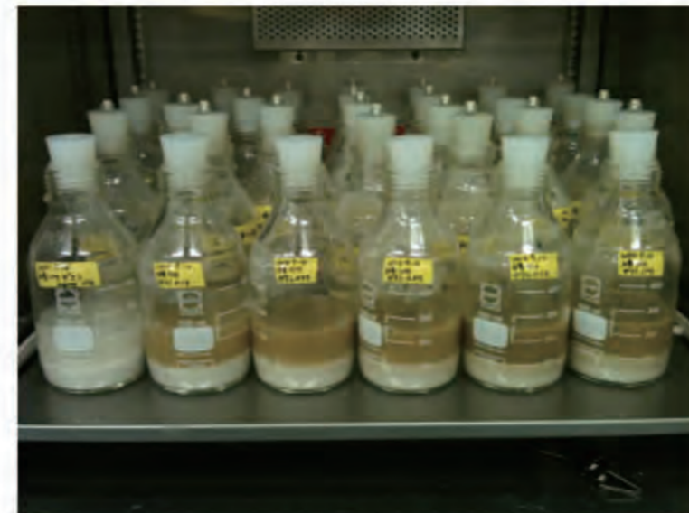
硫化水素発生試験の状況
