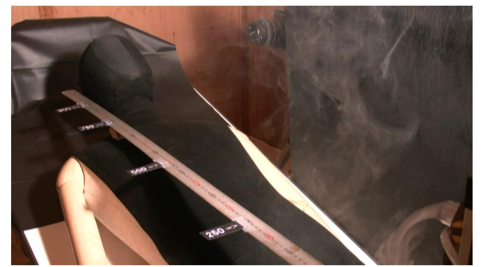
写真1. 噴流方式による医療ガス搬送試験
