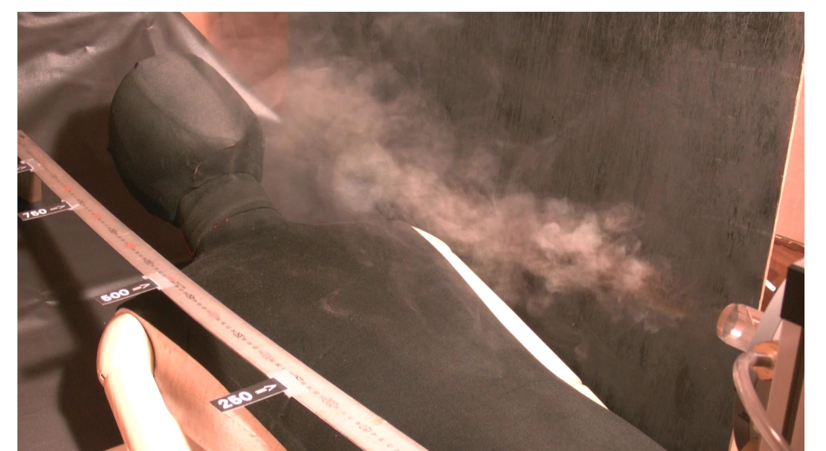
写真2. 渦輪搬送方式による医療ガス搬送試験
