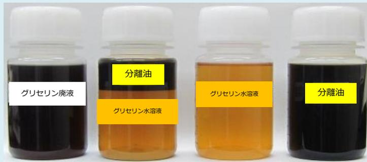
原料のグリセリン廃液と製品のグリセリン水溶液と分離油
