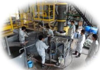
放射能汚染焼却残渣の水洗
